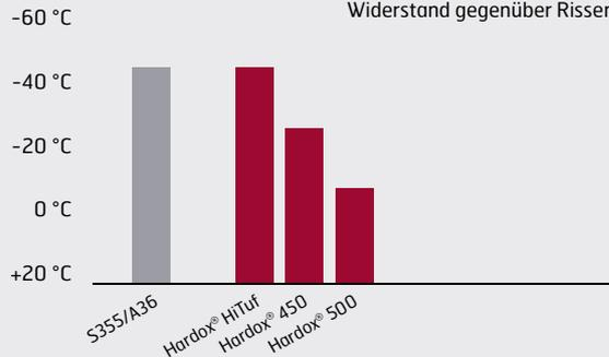
Die Zähigkeitswerte von Hardox® HiTuf, 450 und 500 haben garantierte Mindestwerte von -40 °C, -20 °C bzw. 0 °C. Im Vergleich zu einem herkömmlichen S355 Stahl bietet Hardox® HiTuf beispielsweise eine dreimal höhere Widerstandsfähigkeit gegenüber Verformung (Härtegrad) sowie einen gleichwertigen Widerstand gegenüber Rissen (Zähigkeit).
