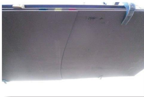
Beispiel eines Dreipunkt-Hebevorgangs mit einem daraus resultierenden Riss.
