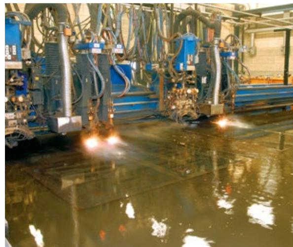
**ABB. 12.** Schneiden unter Wasser.
