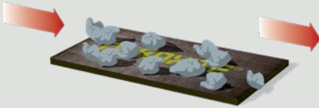
Duroxite™ ist besonders gut zur Bekämpfung von Gleitverschleiß durch außergewöhnlich harte Feststoffe wie quarzhaltige Mineralien geeignet.
