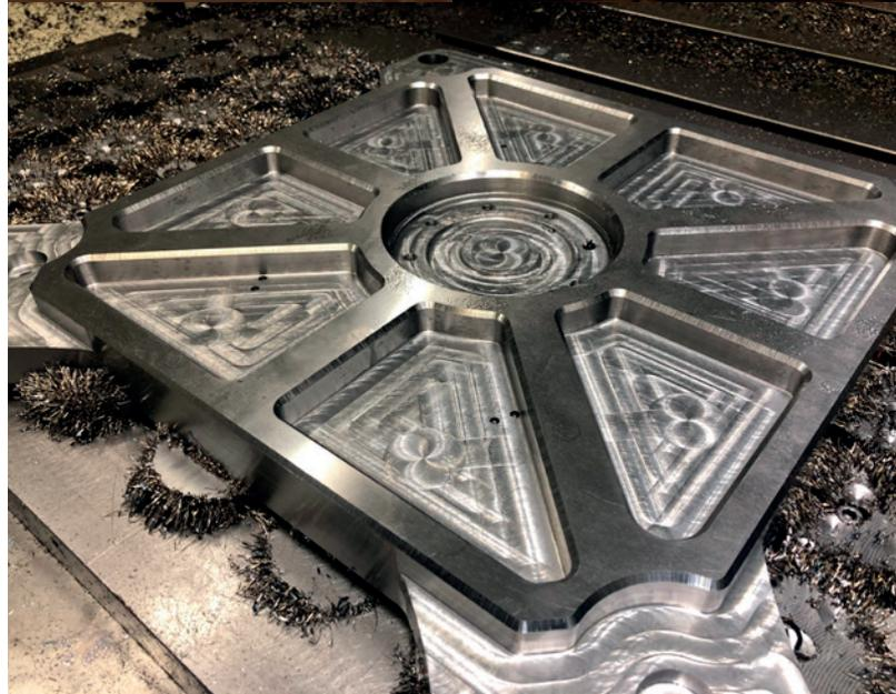
Der unlegierte Werkzeugstahl 1.1730 dient als Aufbaumaterial für Kunststoff- und Stanznormalien, Grundplatten und Rahmen für den Vorrichtungsbau, Werkzeugbauteile, Handwerkzeuge aller Art, landwirtschaftlichen Werkzeugen, Spannvorrichtungen und Konstruktionsteile
